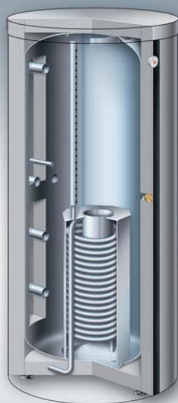
Vitocell 160-E Heizwasser-Pufferspeicher mit innenliegendem Solar-Wärmetauscher und Schichtladeeinrichtung
